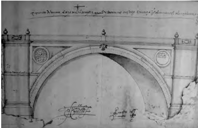
B) Detalle vano central del Puente Mazuecos (S.L; s.n. 1570).
